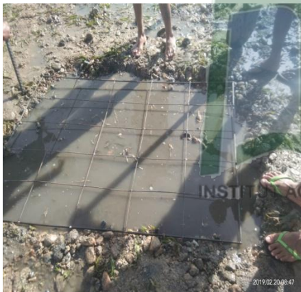
FRAME BESI SEBAGAI PENAHAN BIBIT LAMUN YANG AKAN DITRANSPLANTASI AGAR TIDAK TERBAWA ARUS
