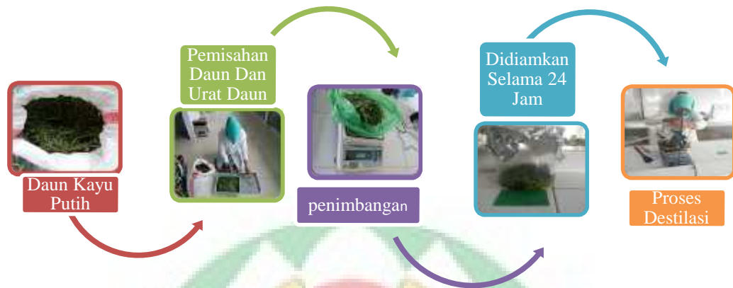
Gambar. 3.2 Prosedur kerja pembuatan minyak kayu putih
