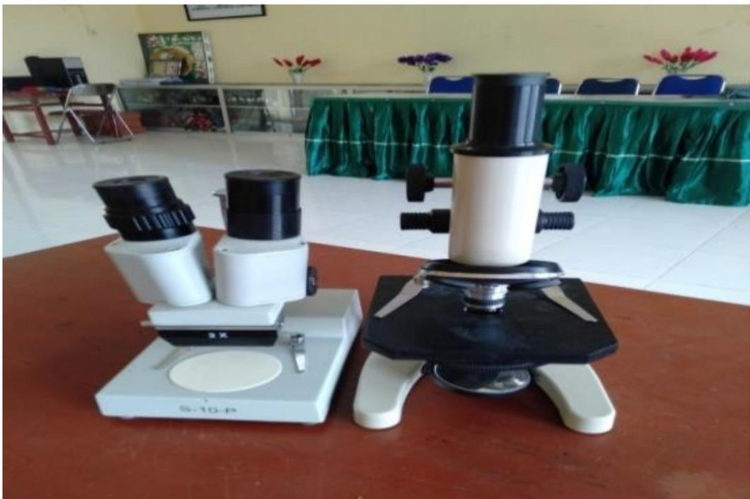
Gambar: mikroskop monokuler dan stereobinokuler
