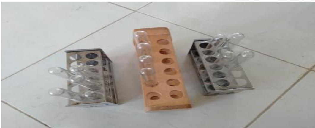
Gambar: Tabung reaksi dan rak tabung reaksi
