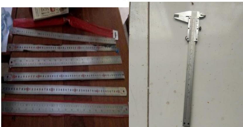
Gambar 2.7. Mistar dan jangka sorong
