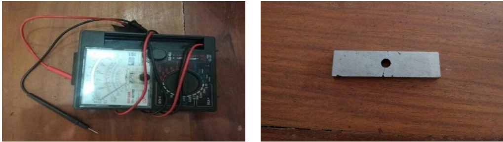
Gambar 2.4. Multimeter AC/DC, 10 kilo ohm/volt dan batang magnet
