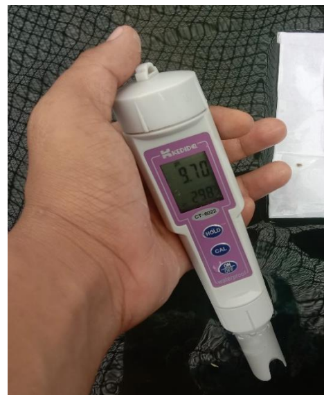
Gambar 10. Pengukuran Suhu dan pH Air
