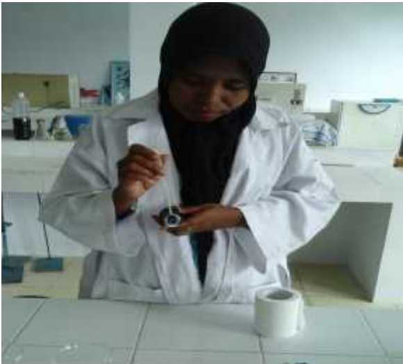
Foto 3. Pengukuran Salinitas Air Laut
