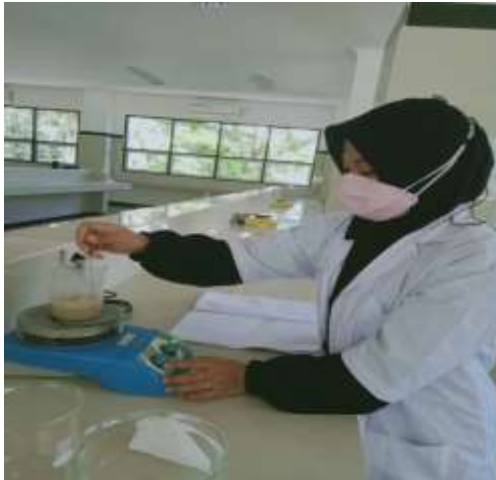
Gambar 13. Pembuatan larutan bioplastik
