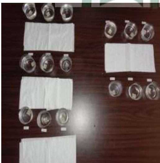
Gambar 17. Pengukuran uji daya serap air
