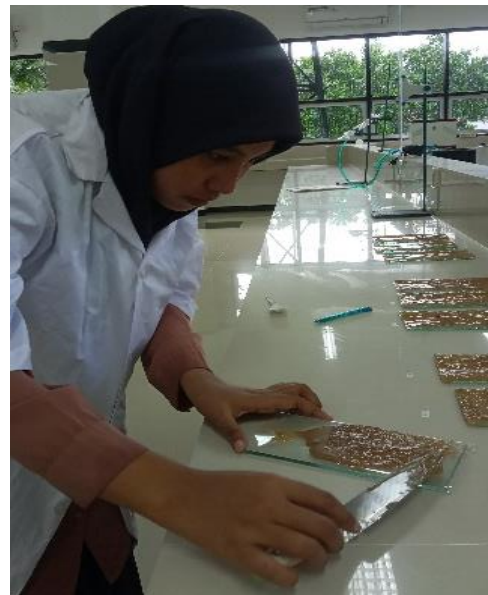
Gambar 12 Pencetakan bioplastik pada wadah kaca 10 x 20
