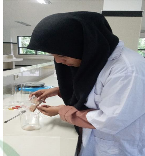
Gambar 8 Penuangan sampel ela sagu, padatan tahu dan penambahan air 50 ml ke dalam gelas kimia
