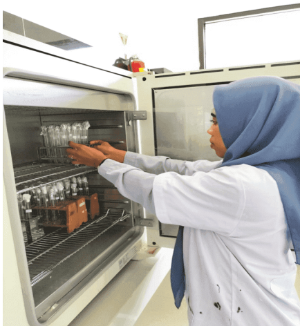
Gambar 6. Memasukan sampel di Dalam inkubator
