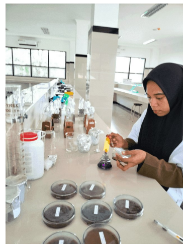
Gambar 11. Memasukan sampel air di dalam media
