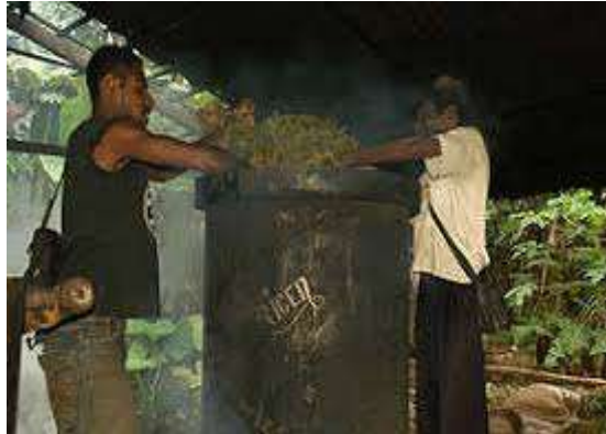
Gambar 22. Proses Penyulingan Dengan Cara Rebus
